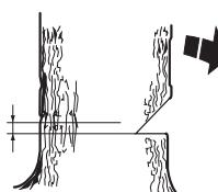
Coloque o apoio para casca (se estiver montado) atrás da linha de ruptura. Serre com aceleração total e deixe a corrente/lâmina penetrar devagar na árvore. Observe se a árvore se move no sentido contrário ao da direcção de queda pretendida. Introduza uma curva de abate ou barra extractora logo que a profundidade de corte o permita.
