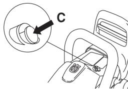
**Puxe o punho de arranque (D):** Puxe o punho de arranque com a mão direita e puxe a corda de arranque lentamente até começar a sentir resistência (quando os prendedores do arranque engatam). De seguida, puxe firme e rapidamente até que o motor dispare. Empurre o estrangulador para dentro logo que o motor dispare, o que pode ser detectado ouvindo um som "puff". Continue a puxar a corda de arranque até o motor arrancar.
