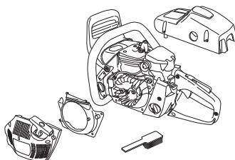
Limpe o sistema de arrefecimento com uma escova, uma vez por semana, ou com mais frequência, em condições de trabalho difíceis. O sistema de arrefecimento obstruído ou sujo conduz a um sobreaquecimento da máquina, danificando o cilindro e o pistão.
