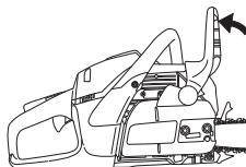
Desenrosque las tuercas de la espada y saque la cubierta del embrague (el freno de cadena). Saque la protección de transporte (A).
