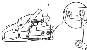
A corrente está correctamente esticada quando não mais estiver frouxa na parte inferior da lâmina e ainda possa ser girada facilmente com a mão. Aperte bem as porcas da lâmina com a chave universal ao mesmo tempo que segura a extremidade da lâmina.
