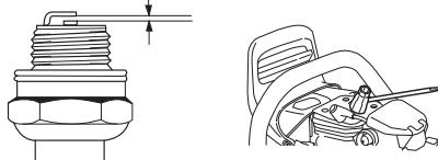
Aclaración! ¡Utilice siempre el tipo de bujía recomendado! Una bujía incorrecta puede arruinar el pistón y el cilindro. Asegúrese de que la bujía tenga supresión de perturbaciones radioeléctricas.
