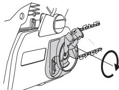
El tensado de una cadena nueva debe controlarse con frecuencia, hasta que se haya hecho el rodaje. Controle el tensado regularmente. Una cadena correcta significa buena capacidad de corte y larga duración.
