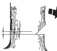
Coloque el apoyo de corteza (si ha sido montado) detrás de la faja de desgaje. Corte con aceleración máxima introduciendo lentamente la cadena/espada en el tronco. Preste atención a si el árbol se mueve en dirección opuesta a la elegida para el derribo. Tan pronto lo permita la profundidad de corte, ponga una cuña de derribo o una barra desgajadora en el corte de derribo.
