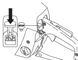
O motor pára ao desligar a ignição.
