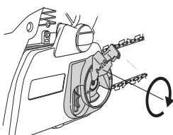
Numa corrente nova, a tensão deverá ser controlada constantemente até concluir a rodagem. Verifique a tensão da corrente regularmente. Uma corrente correcta significa boa capacidade de corte e longa vida útil.
