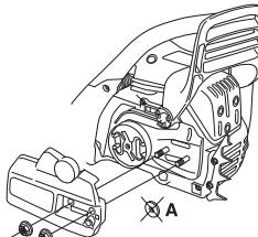
Monte la espada en los pernos. Sitúela en la posición posterior extrema. Monte la cadena en el piñón de arrastre y la guía de la espada. Empiece con la parte superior de la cadena.
