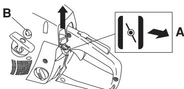
**Válvula de descompresión (C):** Oprima la válvula para reducir la presión en el cilindro y facilitar el arranque de la máquina. La válvula de descompresión debe utilizarse siempre para los arranques. Una vez que ha arrancado la
