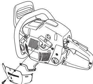
**NOTA!** Se estiver montado o conjunto kit de inverno ou se foram tomadas as medidas para aumento de temperatura, deve retornar-se a uma regulação normal quando a máquina for usada sob condições normais de temperatura. Caso contrário, há risco de sobreaquecimento com sérios danos para o motor.
