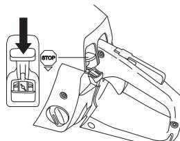
Para parar el motor, desconecte el encendido.
