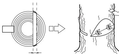
Se pierde completamente el control de la dirección de derribo del árbol si la faja de desgaje es demasiado
