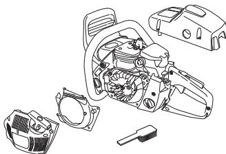
Limpie el sistema refrigerante con un cepillo una vez por semana (en condiciones difíciles, con mayor frecuencia). Un sistema refrigerante sucio u obturado produce sobrecalentamiento de la máquina, con las consiguientes averías del cilindro y el pistón.
