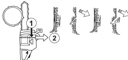
La profundidad del corte de indicación debe ser igual a 1/4 del diámetro del tronco, y el ángulo entre los cortes superior e inferior debe ser de 45° como mínimo.
