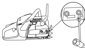
La cadena está correctamente tensada cuando no cuelga en la parte inferior de la espada y puede girarse fácilmente con la mano. Apriete las tuercas de la espada con la llave combinada, sujetando al mismo tiempo la punta de la espada.
