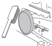
Controle periodicamente se restam pelo menos 0,6 mm da espessura da cinta nas partes de maior desgaste.
