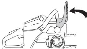
Desmontar la manija y la cubierta del embrague (freno de cadena). Quitar el anillo de transporte.
