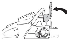
Desmonte o manípulo e a tampa da embraiagem (travão da corrente). Desmonte o anel de transporte.
