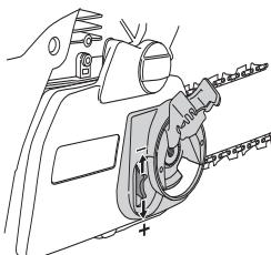
A corrente está correctamente esticada quando não pende na parte inferior da lâmina, mas pode ainda ser rodada facilmente à mão. Segure a ponta da lâmina e aperte a embraiagem da lâmina rodando o manípulo para a direita.
