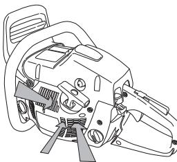
**¡IMPORTANTE!** Para que la depuración centrífuga funcione satisfactoriamente, debe efectuarse un mantenimiento constante del sistema. Limpie la toma de aire del mecanismo de arranque, las palas de ventilador del volante, el espacio alrededor del volante, el tubo de admisión y el compartimiento del carburador.
