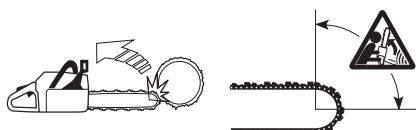
Serrar com a parte inferior da lâmina, ou seja, serrar a partir do lado superior do objecto a ser serrado, e para baixo, chama-se serrar com a corrente a puxar. Então a moto-serra é puxada contra a árvore e o canto anterior do corpo da moto-serra forma um apoio natural contra o tronco. Serração com a corrente a puxar possibilita ao utilizador um melhor controlo sobre a moto-serra bem como sobre onde o sector de risco de retrocesso da lâmina está localizado.
