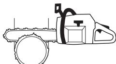
Há métodos para abate de árvores com os diâmetros do tronco maiores do que o comprimento da lâmina. Esses métodos acarretam o grande perigo de que o sector de risco de retrocesso da lâmina entre em contacto com algum objecto.
