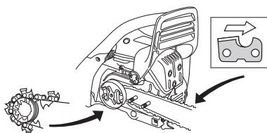
Verifique se o fio dos elos de corte está voltado para a frente, na parte superior da lâmina.
