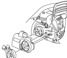
Monte a lâmina nos seus parafusos. Coloque a lâmina na sua posição mais atrás. Ponha a corrente sobre o pinhão da
