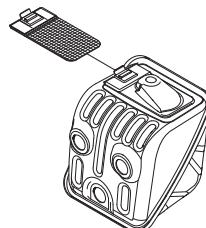
O silenciador é configurado para abaifar o nível de ruído e para conduzir os gases de escape para longe do utilizador. Os gases de escape são quentes e podem conter faíscas que podem causar incêndios, se os gases forem dirigidos contra um material seco e inflamável.
