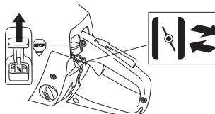
**Aceleración de arranque:** Para la función combinada de estrangulamiento / aceleración de arranque ponga el estrangulador como se indicó anteriormente.
