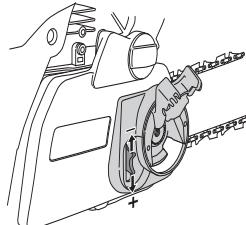
La cadena está correctamente tensada cuando no tiene deflexión en la parte inferior de la espada y se puede girar fácilmente a mano. Sujetar la punta de la espada y apretar el embrague de la espada girando la manija a derechas.
