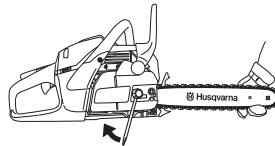
El tensado de una cadena nueva debe controlarse con frecuencia, hasta que se haya hecho el rodaje. Controle el tensado regularmente. Una cadena correcta significa buena capacidad de corte y larga duración.
