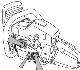
**IMPORTANTE!** Para conservar a função de purificação centrífuga, é necessário prestar assistência e manutenção contínuas. Limpe a entrada de ar do dispositivo de arranque, asas de ventoinha da cambota, compartimento em torno da cambota, tubo de admissão e compartimento do carburador.
