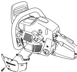
**¡NOTA!** Si se ha montado el conjunto especial de invierno o si se han tomado medidas para aumentar la temperatura, debe cambiarse al reglaje normal, puesto que la máquina funciona con temperatura normal. De lo contrario, hay riesgo de sobrecalentamiento con las consiguientes averías graves del motor.
