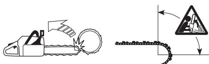
O retrocesso desloca-se sempre na direcção do plano da lâmina. Mais comum é que a moto-serra e a lâmina sejam arremessadas para cima e para trás, contra o utilizador.
