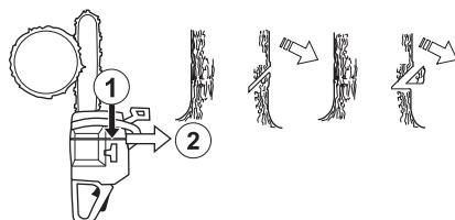
A profundidade do corte direccional deve ser de 1/4 do diâmetro do tronco e o ângulo entre o corte superior e o inferior, no mínimo de 45°.
