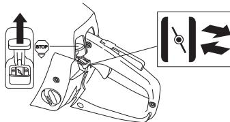
**Aceleração de arranque:** A posição correcta estrangulador/acceleração de arranque obtém-se ao colocar o controlo como referido em cima.
