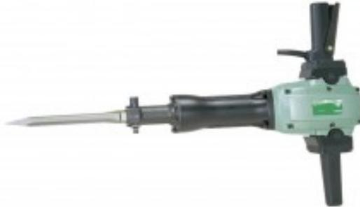
El más compacto martillo demoledor para trabajos verticales con sólo 625 mm. de altura y 42 J. de fuerza de picada. Empuñadura con amortiguación. Sistema de ventilación del motor dotado con doble protección evitando la entrada de cuerpos extraños. Uso continuo en trabajos duros.
