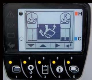
**Ajuste del caudal de aceite máximo (circuitos aux. 1 y 2)**
