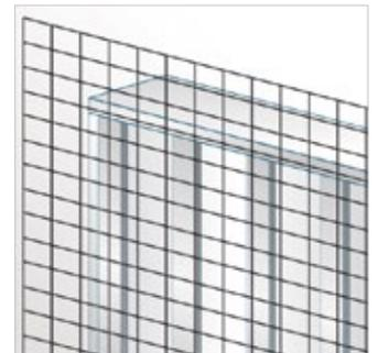
Red metálica de medidas superiores en caso de instalación en paredes de obra.
