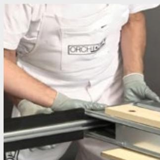
Montar la guía y montante en el armazón.
