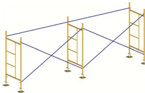
Colocar las plataformas fijas, la plataforma de acceso y el soporte de escalera. Apoyar la escalera sobre el soporte.
