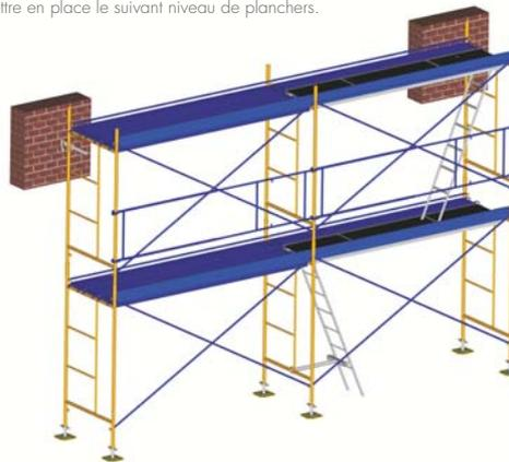
En el último nivel completar con marcos cortos y montar la protección lateral con barandillas y rodapiés.
