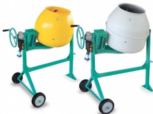
Gracias a sus volantes de tipo sinfin, reducen al máximo el esfuerzo personal del operario durante su basculación, permitiendo a su vez este sistema posicionar las cubas de amasado con la inclinación exacta y precisa.
