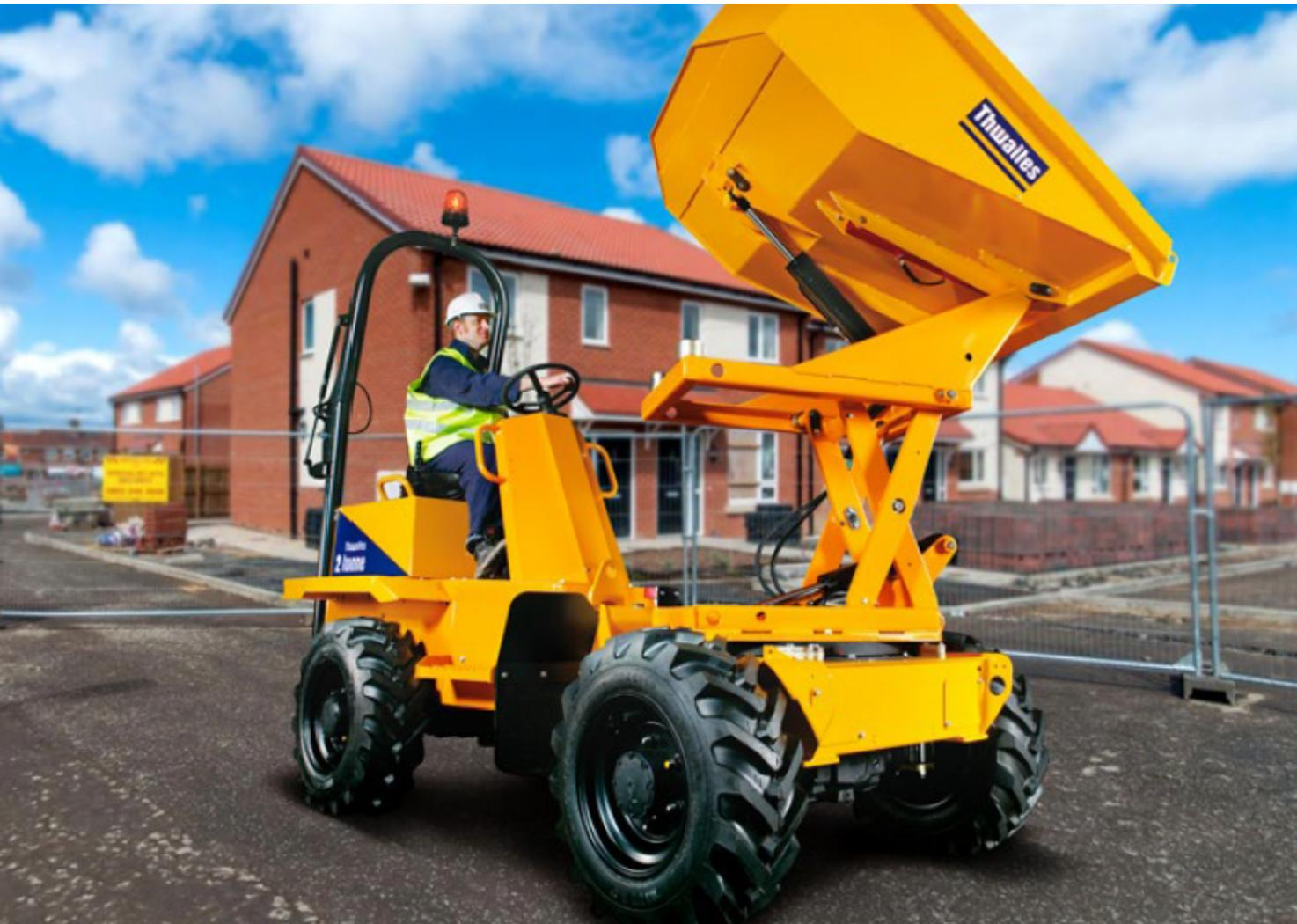
El motor Yanmar (Stage V, sin DPF) de tres cilindros, junto con una transmisión hidrostática y ejes Dana otorgan a este dumper fiabilidad, rendimiento y capacidad todoterreno para ofrecer una gran productividad.
